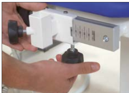
Fase 2: haciéndolo deslizar posicionar el dispositivo de bloqueo para después fijarlo a la barra lateral.
